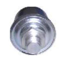
Sensor Pressão do Óleo 0-10Bar Rosca M16x1,5 P Alarma 5 BAR
