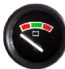
Indicador de Combustível 12V (V=1 CH=85) 52mm
