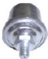
Sensor de Pressão do Óleo 0-10Bar - M10x1,0
